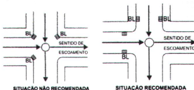
Figura 2 - Esquema representativo do padrão escolhido para disposição das bocas de lobo em interseções (ADASA, 2018).
