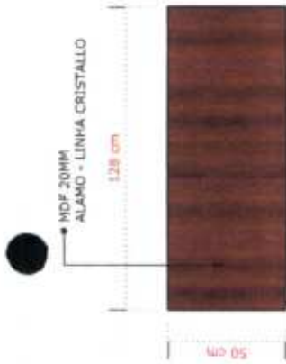
02- VISTA SUPERIOR MB19 ESCALA.....1/20
