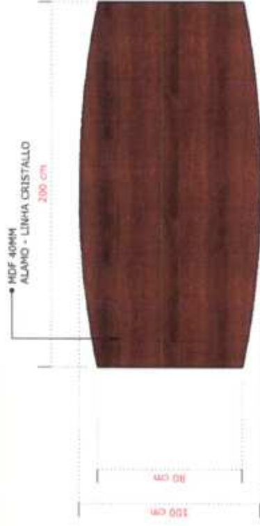
02 - VISTA SUPERIOR MB8 ESCALA.....1/20
