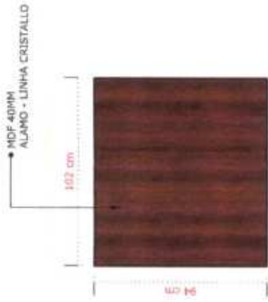
02- VISTA SUPERIOR PEÇA 3 MB10 ESCALA.....1/20
