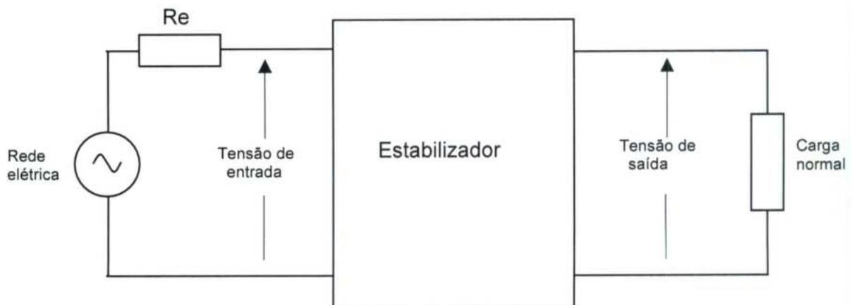
**Figura 7 — Circuito elétrico utilizado na medição da regulação de saída com 90% de carga normal**
